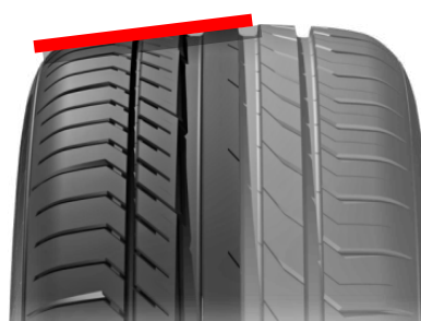
Figura 10. Efecto de un camber negativo en los neumáticos.
