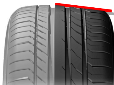
Figura 11. Efecto de un camber positivo en los neumáticos.
