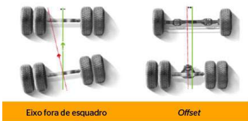
Figura 29. Representación de los problemas de alineación de los ejes.
