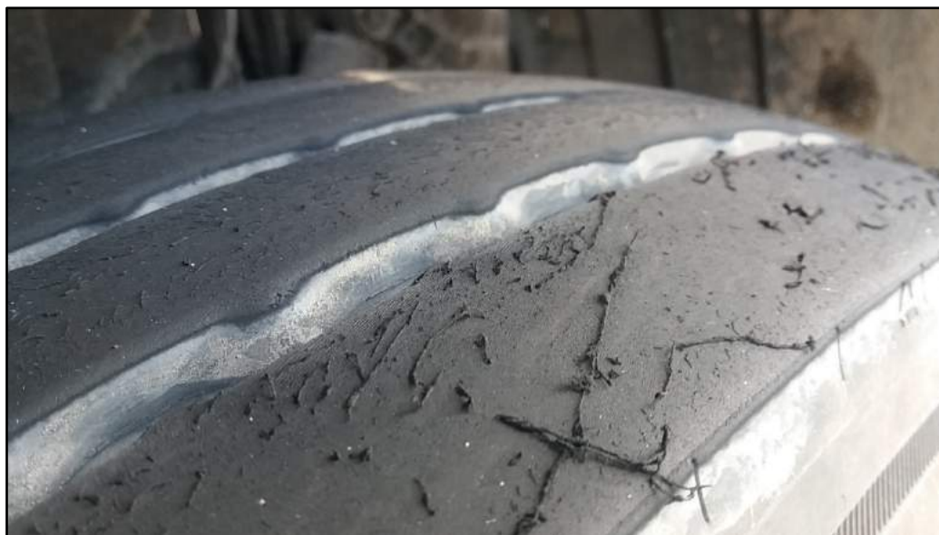
Figura 22. Ejemplo de neumático bajo la condición de arrastre lateral forzado por desalineación.
