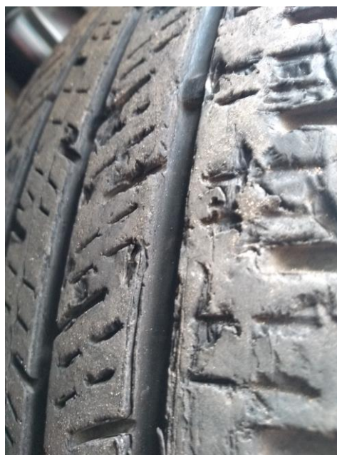
Imagen 3: Ejemplo de banda de rodadura bajo acción de arrancamientos.
