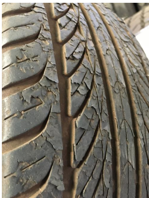
Imagen 2: Ejemplo de banda de rodadura bajo acción de delaminación.
