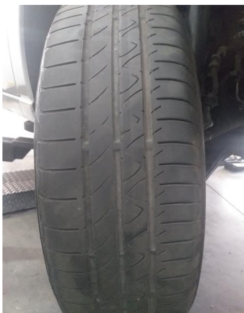
Imagen 1: Neumático con desgaste en la banda de rodadura que hay alcanzado el TWI.
