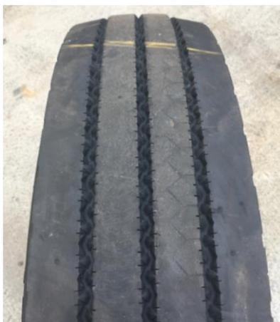
Imagen 2: Apariencia de un neumático con desgaste en los hombros.
