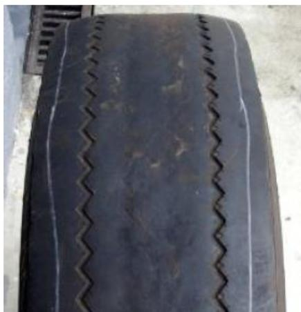
Imagen 1: Apariencia de un neumático con desgaste en el centro de la banda de rodadura.
