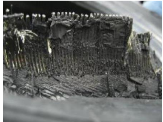
Imagen 5: Hilos expuestos cubiertos con caucho.
