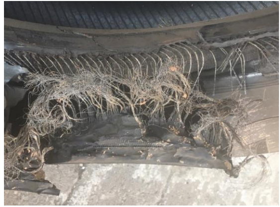
Imagen 3: Hilos expuestos sin ninguna cubierta de caucho.
