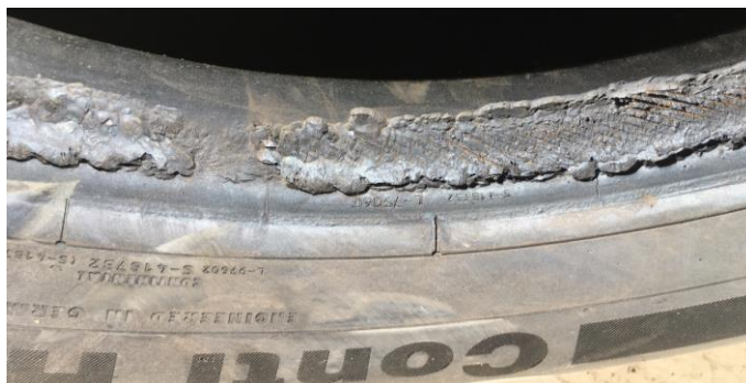
Imagen 2: Apariencia de un talón dañado por la temperatura.
