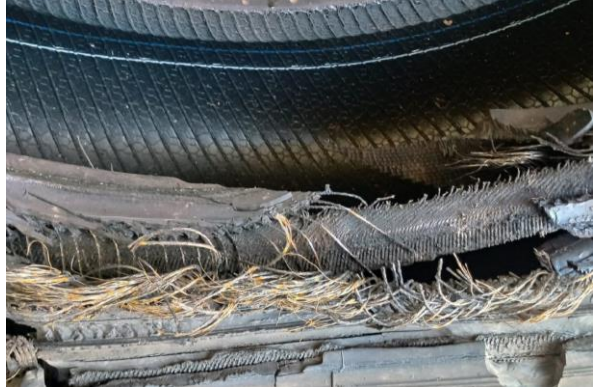
Imagen 4: Hilos expuestos con caucho solo en la base.
