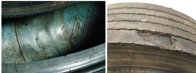
Imagen 6: Separación de las cintas estabilizadoras, causada por contaminación de un reparo inadecuado.
