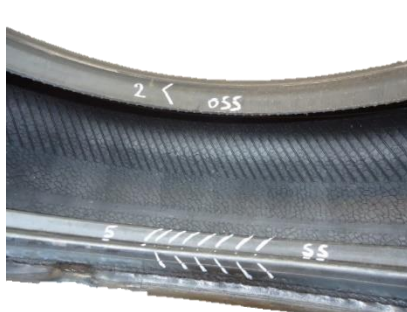
Imagen 3: Separación en la extremidad de las cintas estabilizadoras, causada por la deformación del talón decurrente del asentamiento incorrecto.
