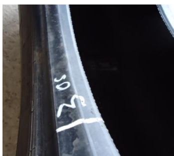
Imagen 3: Separación en la extremidad de las cintas estabilizadoras, causada por la deformación del talón decurrente del asentamiento incorrecto.
