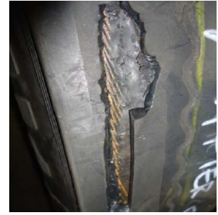
Imagen 4: Separación en la extremidad de las cintas estabilizadoras, causada por el desgaste irregular de la banda de rodadura.
