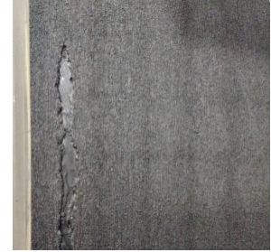
Imagen 5: Deformación en de los neumáticos y separación de las cintas estabilizadoras, causada por la sobrecarga del vehículo.
