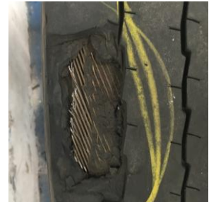
Imagen 6: Separación de las cintas estabilizadoras, causada por contaminación de un reparo inadecuado.
