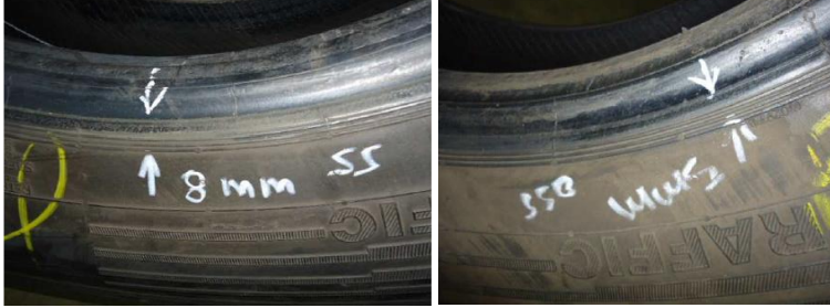
Imagen 5: Deformación en de los neumáticos y separación de las cintas estabilizadoras, causada por la sobrecarga del vehículo.
