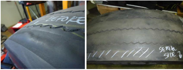
Imagen 4: Separación en la extremidad de las cintas estabilizadoras, causada por el desgaste irregular de la banda de rodadura.
