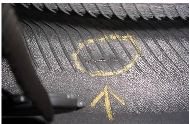
Imagen 2: Marca en la parte interna del neumático, en la misma región del globo.
