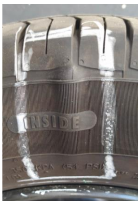
Imagen 1: Globo proveniente de un impacto en la lateral de un neumático.
