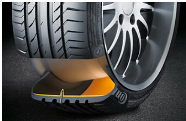
Ilustração 2: Representação de uma perfuração em um neumático ContiSeal.
