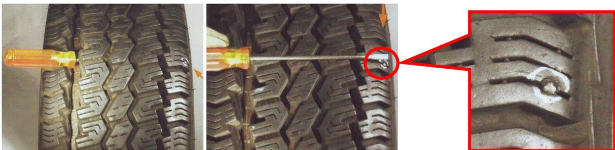
Imagen 3: Contaminación generada por un furo en la banda de rodadura.
