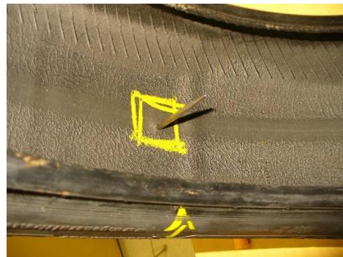
Imagen 2: Ejemplo de una perforación en un neumático de paseo.
