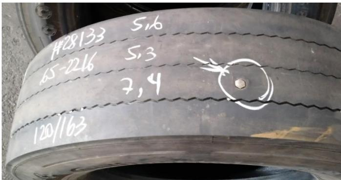
Imagen 1: Ejemplo de una perforación en un neumático de carga.
