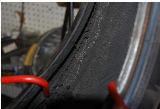
*Imagen 1: Apariencia de un neumático con el liner degradado debido a utilización en baja presión.*
