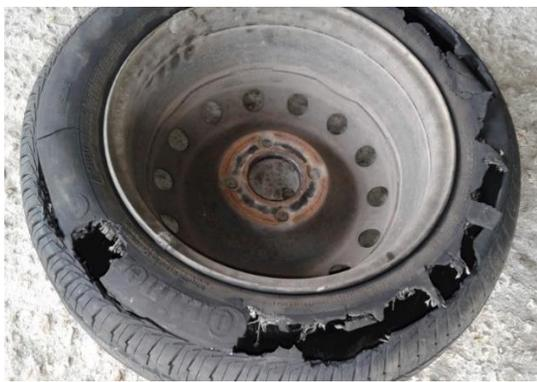
*Imagen 3: Apariencia de un neumático con degradación severa y separación total de los componentes, debido a la rodaje con baja presión.*
