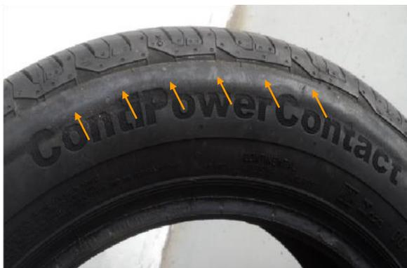
*Imagen 2: Marcación circunferencial en la lateral de un neumático debido a la utilización en baja presión.*
