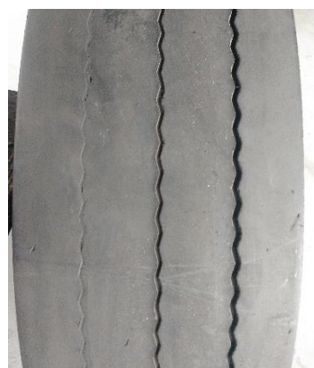
Imagen 1: Apariencia de un neumático con desgaste en solo un hombro.
