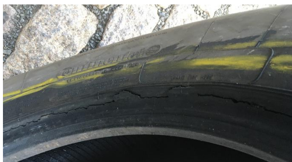
Imagen 2: Ejemplo de un neumático con Imprinting en estado avanzado, ya presentando grietas.
