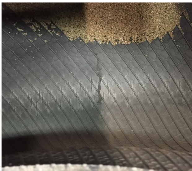
Imagen 1: Grietas en el liner causadas por el compuesto usado para balanceo interno.
